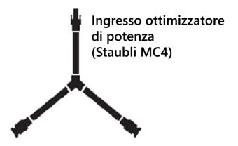
"+" e "-" del modulo FV (identici ai connettori del modulo)
